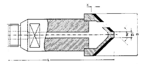
LA CALIDAD DEL CHAFLÁN DEPENDE EN GRAN PARTE DE LA VELOCIDAD DE AVANCE. RECOMENDAMOS UN AVANCE MÁXIMO DE 60 MM/MIN Y UN AVANCE MÍNIMO DE 20 MM/MIN
