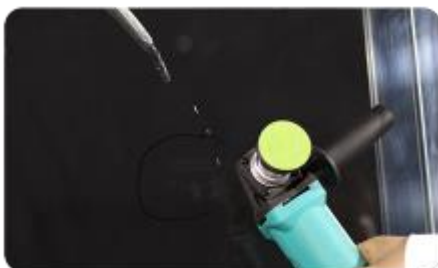
Pegue el disco lapeador en el porta disco
