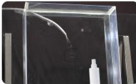
Atomice agua constantemente durante el proceso para enfriar el vidrio
