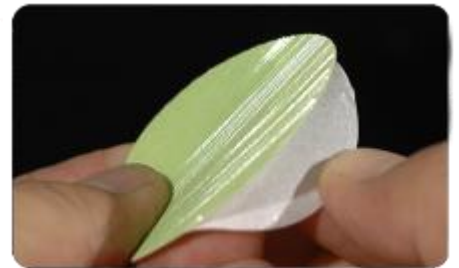
Desprenda el plástico del respaldo del disco lapeador
